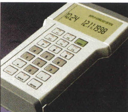
AHB655F (表示窓無し) AHB655D (表示窓付69×37mm) バッテリー：単3電池2、4、6本 006P用電池1~2個
