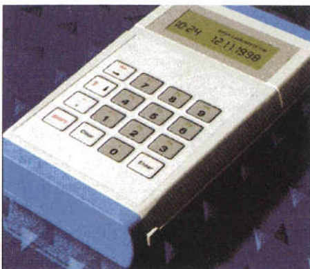
AHB555F (表示窓無し) AHB555D (表示窓付54×20mm) バッテリー：単3電池2~3本 006P用電池1~2個
